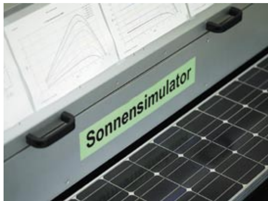
Mit teilweise selbst entwickelter Technik stellt man am HTI Photovoltaiklabor Komponenten auf die Probe – hier der Modulmessplatz.
