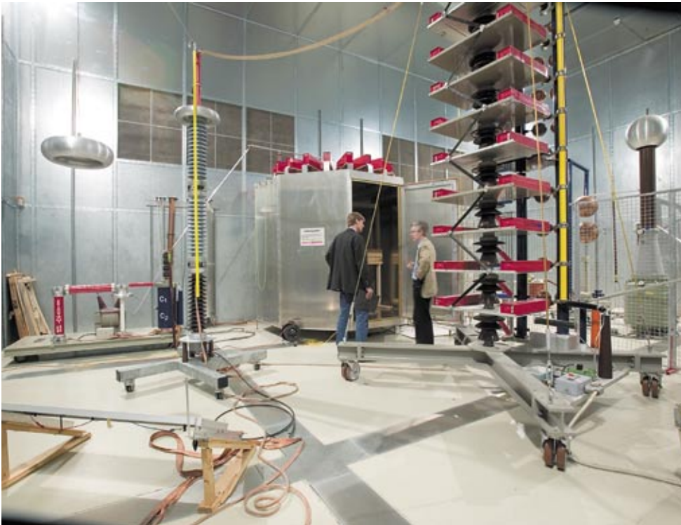
Blitzeinschlag auf Knopfdruck: Im Hochspannungsraum des HTI-Photovoltaiklabors lassen sich extreme Belastungen simulieren.
