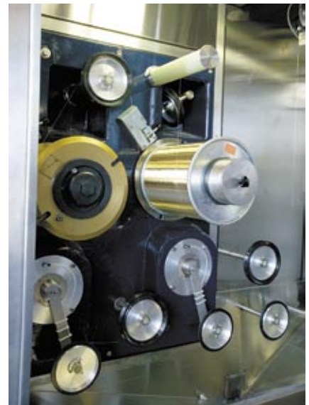
Haarfein und fast unendlich lang: Hunderte Kilometer Draht sind für das Sägen eines Ingots nötig.
