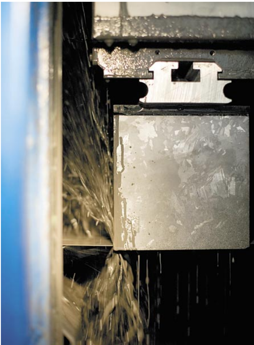
Einschnitt: Millimeterweise arbeitet sich der Draht in den Siliziumblock.
