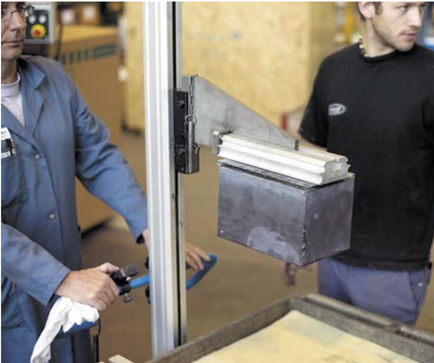
Fixiert: Der zuvor an einer Halterung befestigte Siliziumblock wird zur Säge transportiert.
