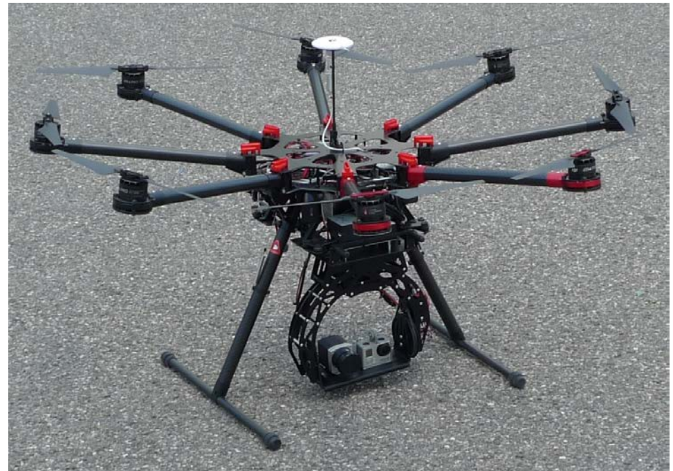
DJI S1000 Oktokopter mit installiertem Kamera-System
